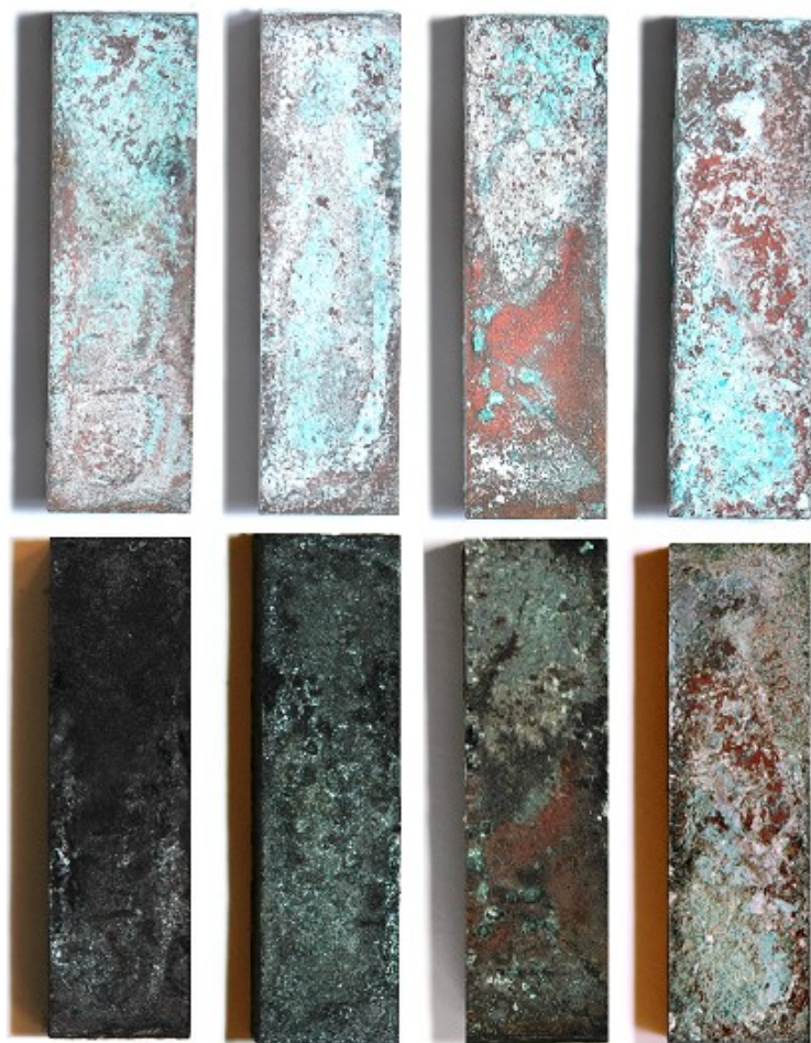
Obr. 19 Vzorky S5, S6, S7 a S8 (zleva) před (nahore) a po (dole) plazmochemickém opracování
