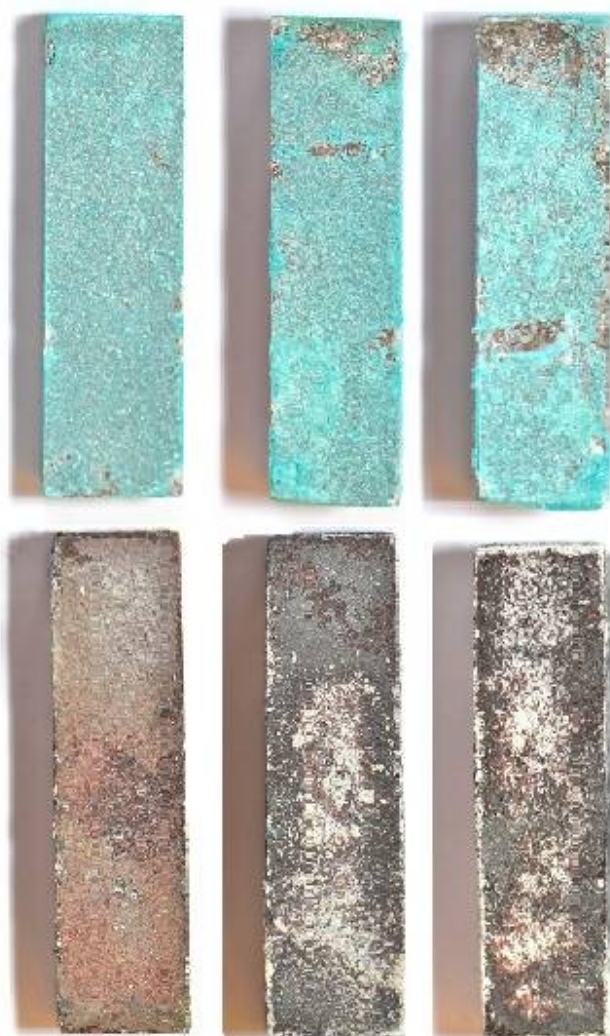
Obr. 29 Vzorky C1, C2 a C3 (zleva) před (nahore) a po (dole) plazmochemickém opracování
