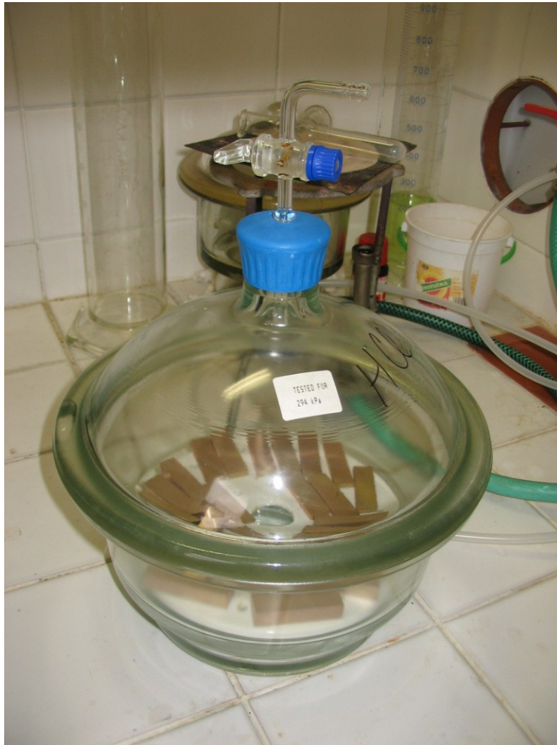
Obr. 45 Exsikátor s bronzovými vzorky korodujícími v parách kyseliny chlorovodíkové
