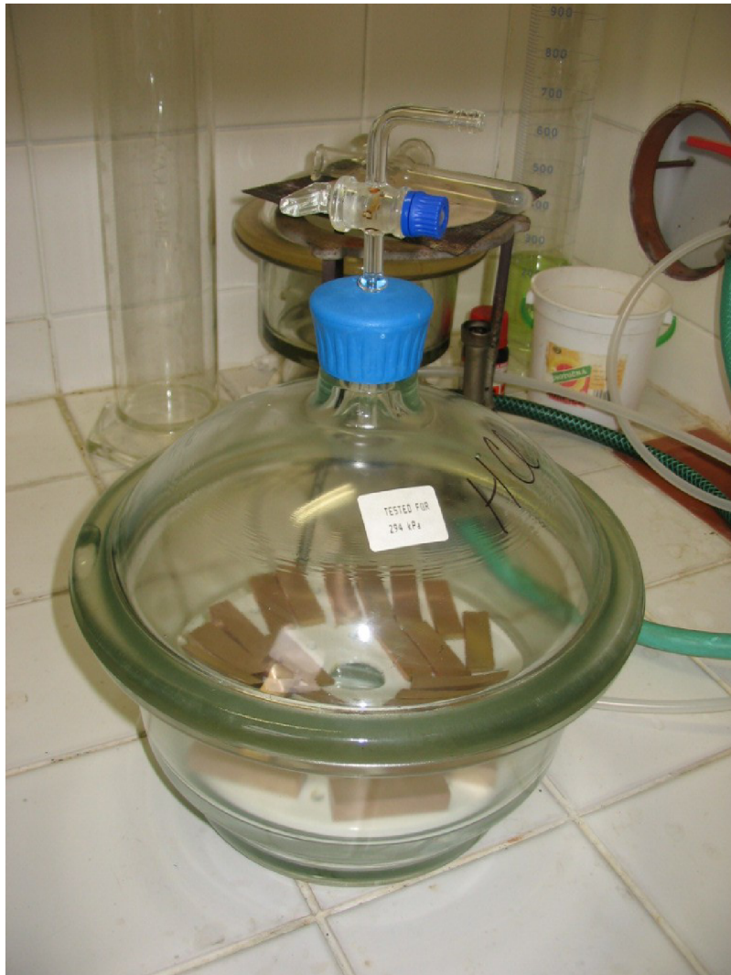
Obr. 45 Exsikator s bronzovými vzorky korodujícími v parách kyseliny chlorovodíkové
