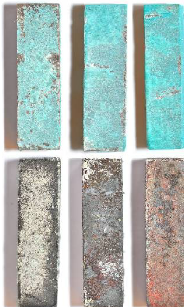
Obr. 32 Vzorky C4, C5 a C6 (zleva) před (nahore) a po (dole) plazmochemickém opracování
