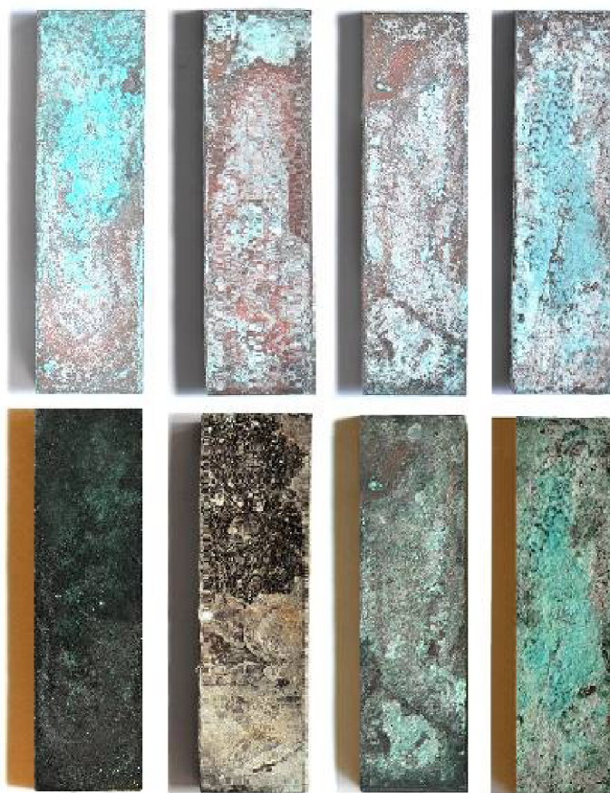
Obr. 16 Vzorky S1, S2, S3 a S4 (zleva) před (nahore) a po (dole) plazmochemickém opracování
