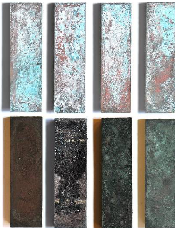
Obr. 22 Vzorky S9, S10, S11 a S12 (zleva) před (nahore) a po (dole) plazmochemickém opracování
