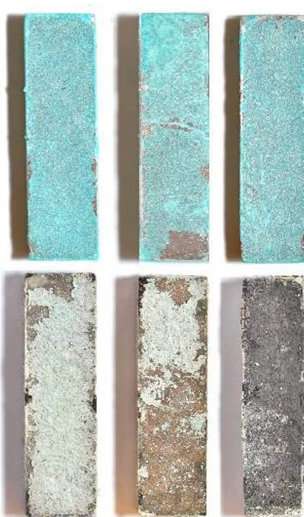
Obr. 38 Vzorky C10, C11 a C12 (zleva) před (nahore) a po (dole) plazmochemickém opracování
