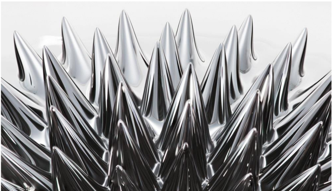
Obrázok 1: Špecifické “ostne” ferrofluidu spôsobené pôsobením magnetického poľa 21
