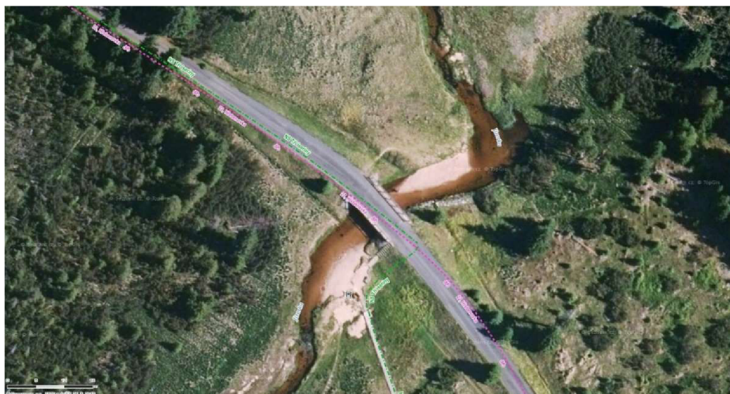
Obrázek 13: Lokalita 3: úsek se nachází za mostem Jizerské silnice (směr toku se shora dolu), patrné jsou písčité podélné akumulace (náplň konvexního břehu), konkávní tůň, Znát jsou i nátrže v konkávním břehu – patrná nepravidelní linie břehu. Zdroj: Mapy.cz ©2019
