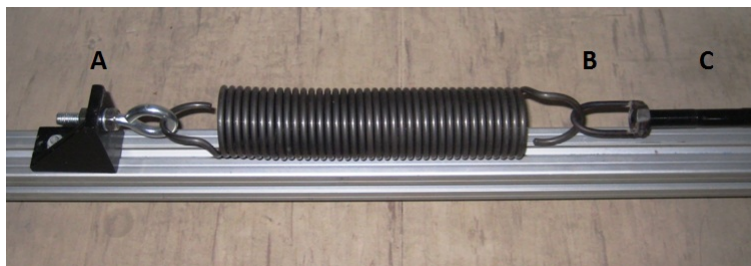
Obrázek 4.9: Pružina představující zátěž, instalována na stojanu
