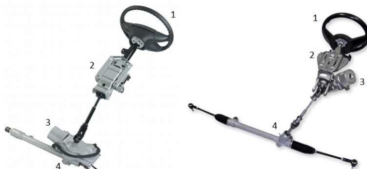
Obrázek 2.2: Elektrický posilovač řízení EPS - dva způsoby montáže elektromotoru [16]
