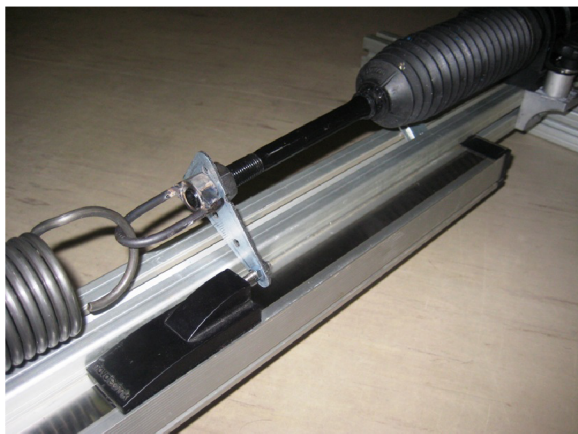
Obrázek 4.3: Potenciometr na stojanu
