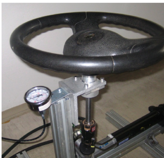
Obrázek 4.4: Manometr na stojanu
