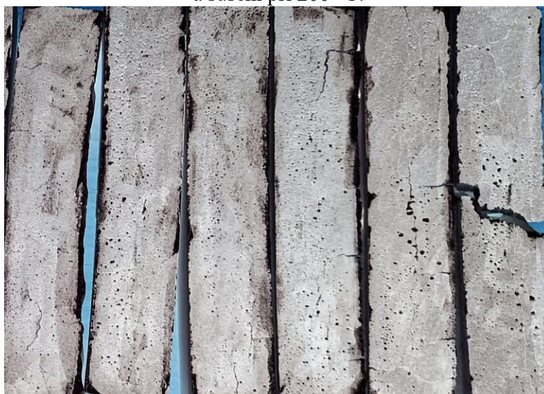
Obrázek 5.10: Vysušené vzorky modelové směsi křemičitého solu po 8 h gelace, sušené při 200 °C (3 vlevo) a 300 °C (3 vpravo)
