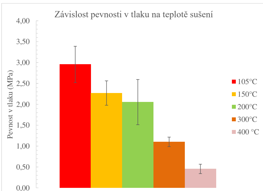
Příloha 15: Graf závislosti pevnosti v tlaku na teplotě sušení pro vysušené vzorky reálné směsi
