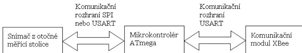
Obrázek 10 - Schéma funkce zařízení z měřicí stolice
