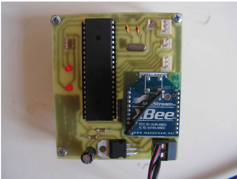
Obrázek 21: Fotografie komunikačního zařízení na straně senzoru
