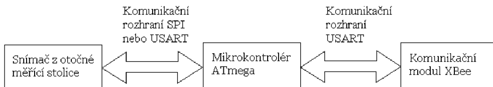
Obrázek 10 - Schéma funkce zařízení z měřicí stolice
