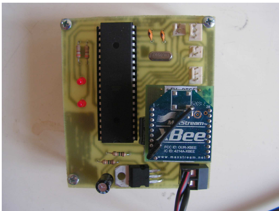
Obrázek 21: Fotografie komunikačního zařízení na straně senzoru
