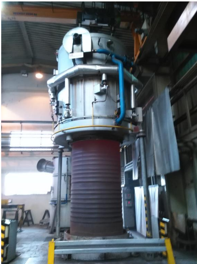
Obr. 10 Komerová (zvonová) žihací pec typu ATI (METALDYNE spol. s r.o., 2015)
