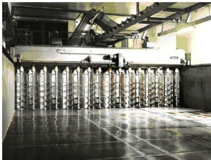
obr.18 - Šnekový obraceč Saladinovy skříně ( www.schmidt-seeger.com )
