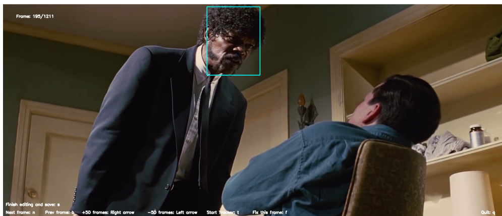
Obr. 5.9: Ukážka užívateľského rozhrania pre anonymizačný systém. Ovládacie prvky sú zobrazené na spodnom okraji obrazu a ovládanie sa realizuje cez klávesy, prípadne myšou pri výbere objektu. Na obrázku je vidieť aj ako vyzerá označený objekt pre anonymizáciu.
