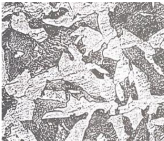
Obr. 4.1 Mikroštruktúra ocele 13 240 tepelne nespracovaná zv.534x [10]
