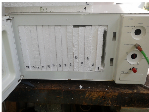
Obrázek 13: Kladení polystyrenových desek ve vertikálním směru. Směr papíru je kolmý na průnik vln.
