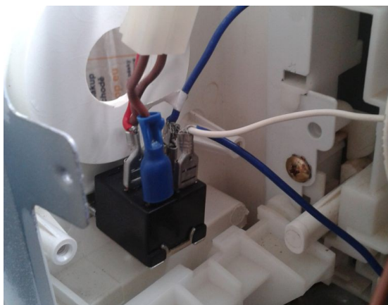
Obrázek 34: Napojení větráku a přívodu proudu na jeden vypínač.
