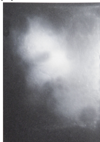
Obrázek 46: Vzorek PVB-17a – s polem, výkon 39,8 W, bez zakrytých děr, resp. s větrem od ventilátoru. Vlákna jsou po celé ploše podkladového papíru.
