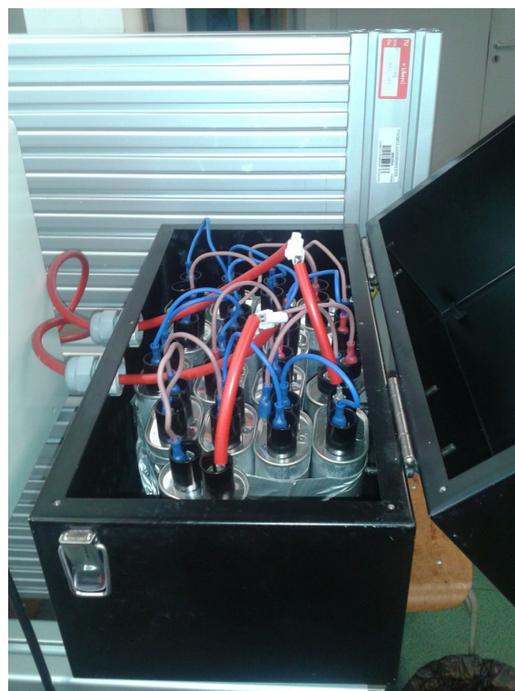
Obrázek 20: Krabice se sériově zapojenými kondenzátory.
