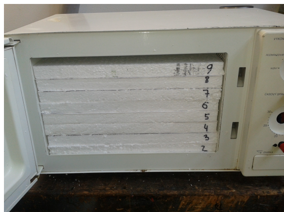
Obrázek 14: Kladení polystyrenových desek v horizontálním směru.
