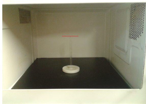
Obrázek 39: Rozdíl ve výšce spinneru oproti obr. 38– vyšší poloha – vlákna se zachytávají pouze na kolektoru.
