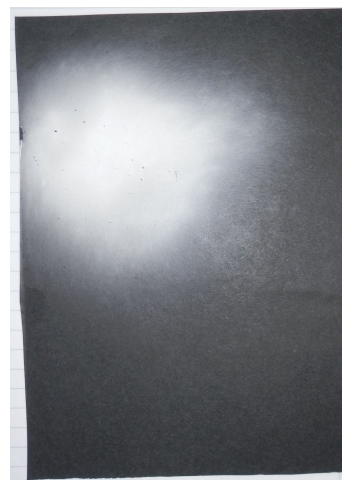
Obrázek 48: Vzorek PVP10-5b – výkon 123,3 W vzorek s polem, se zakrytými děrami. Vlákna jsou uložena na jednom místě ne po celém papíru.
