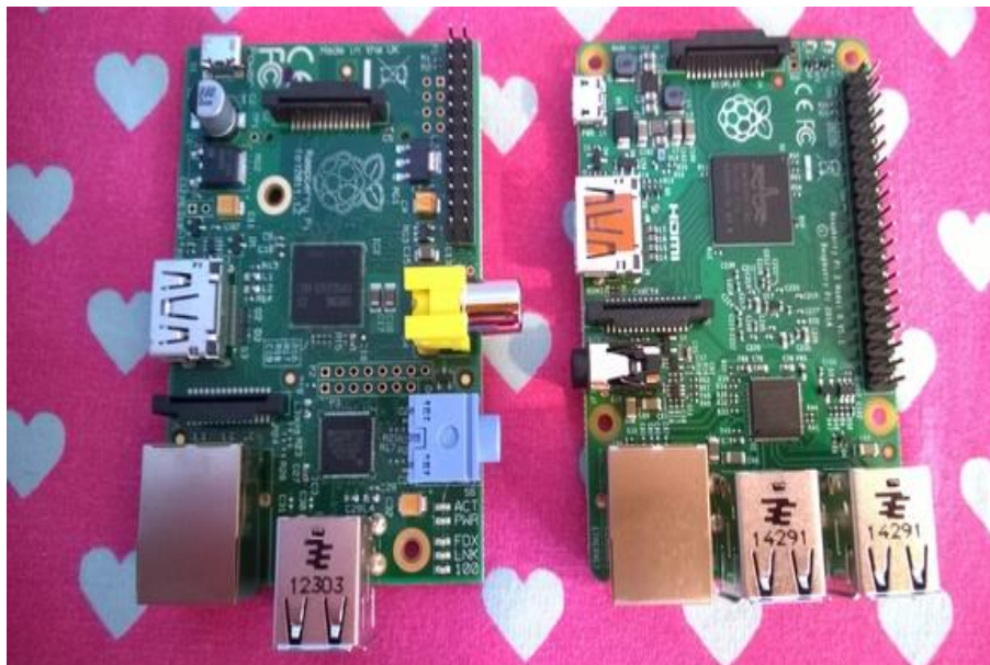
Obrázek č. 2.: Raspberry Pi model B (vlevo) s Raspberry Pi 2 model B (vpravo),
