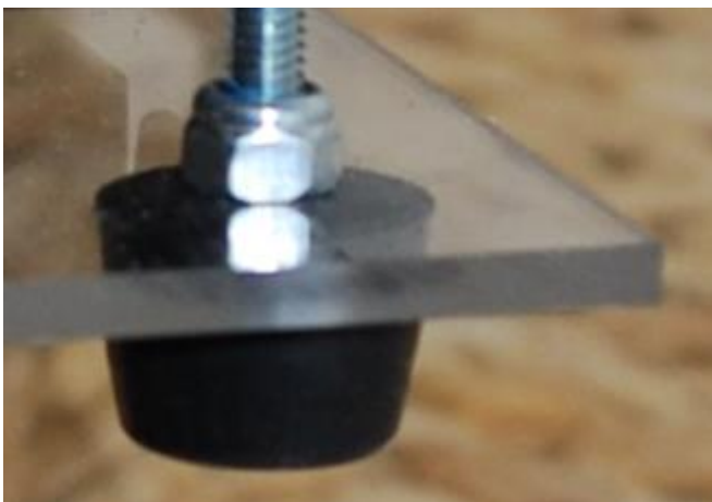
24. Upevněná nožička matkou
