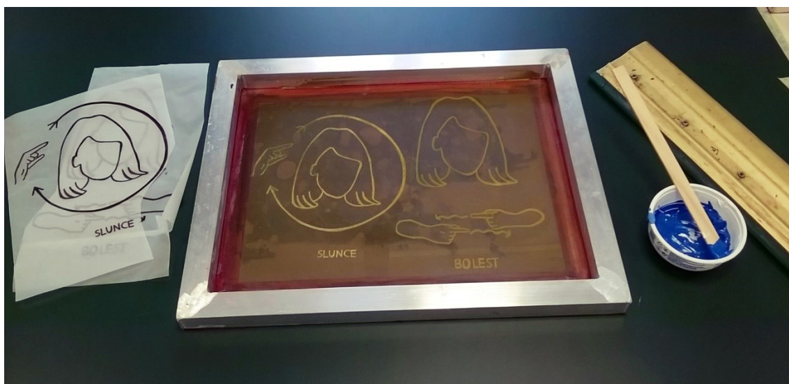
Obrázek 34 Příprava sítotisku: zleva šablony na voskovaném pauzovacím papíru, osvitem vytvořené síto, jedna z namíchaných barev a těrka
