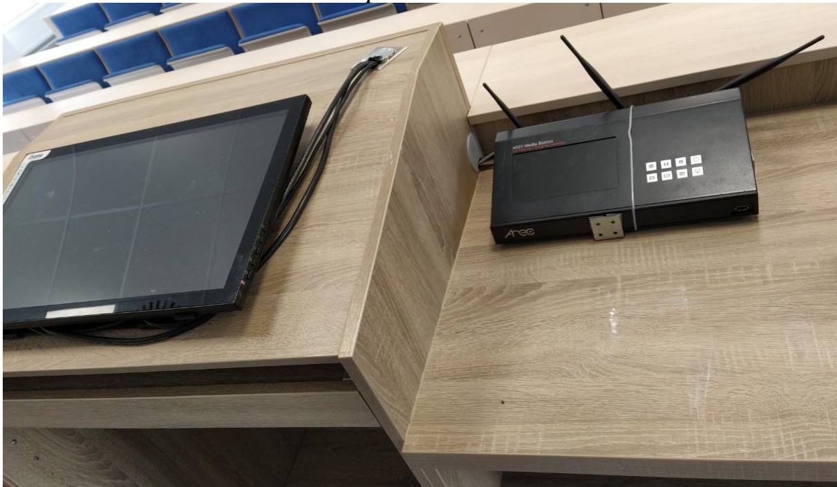
Obrázek 38: Finální podoba instalace rekordéru AREC
