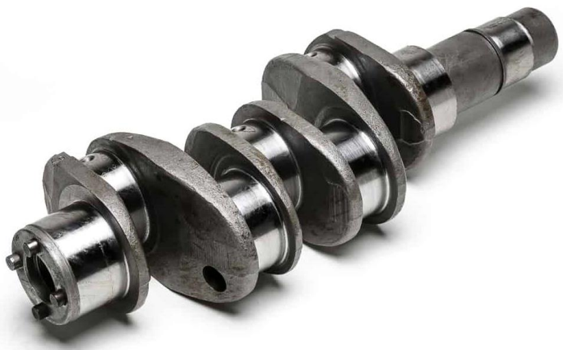
Obrázek 3: Příklad kovaného KH VW [17]
