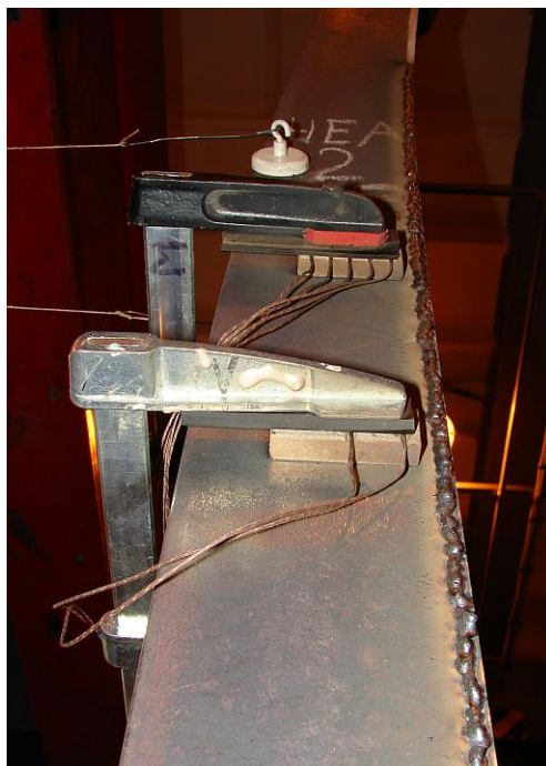
Obr. 5.29: Měření termočlánky přes azbestovou destičku přitlačenou svěrkou na sloupech HEA2 a SHS1
