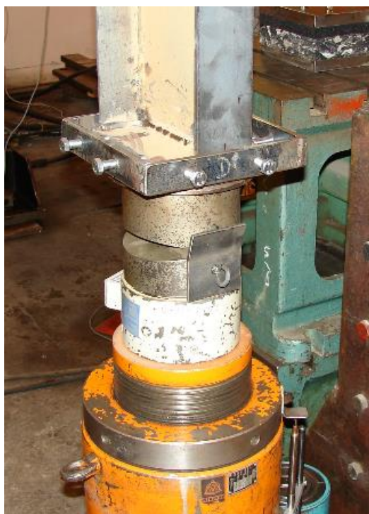
Obr. 5.3: Uložení pomocí břitového ložiska – fotografie a schéma – sety (A), (B) a (C)
