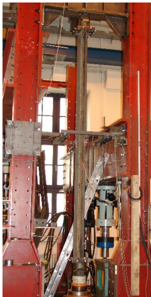
Obr. 5.2: Zkušební sestava – fotografie a schéma; pozice tenzometrů (SG), lankových snímačů (DWS) a úchylkoměru (LVDT)
