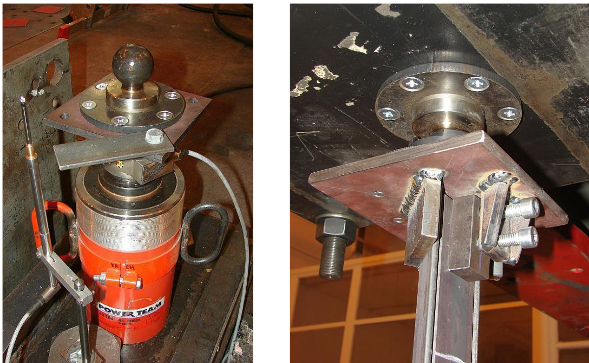
Obr. 5.20: Spodní kulové ložisko se zatěžovací sestavou – zatěžovací válec, siloměr a snímač polohy; horní ložisko s osazeným prvkem připraveným ke svařování
