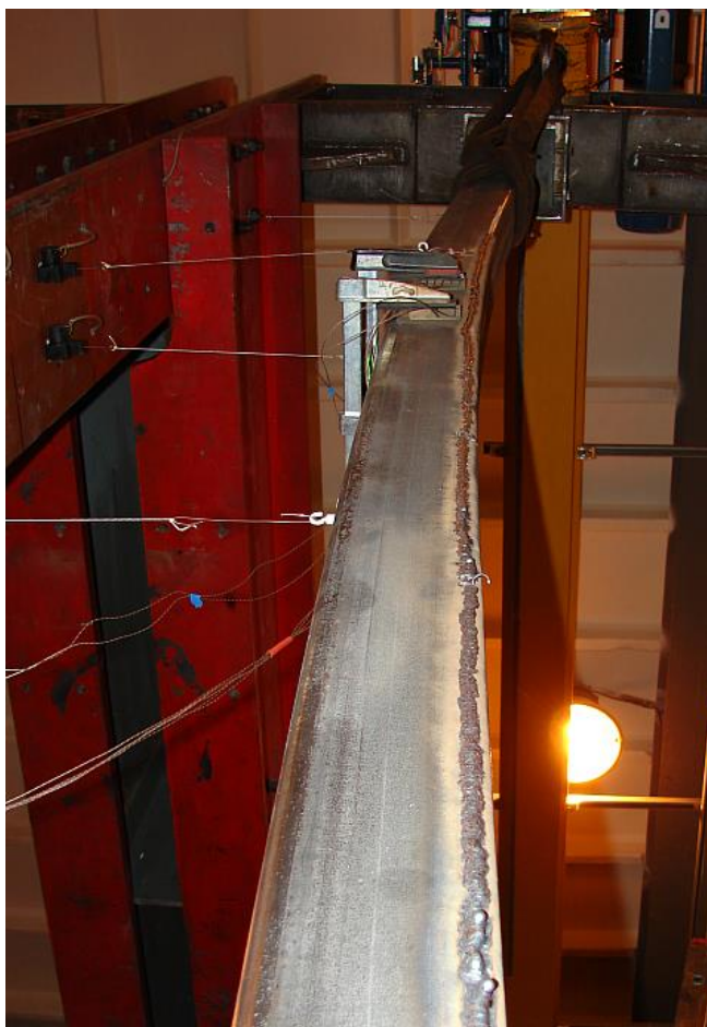
Obr. 5.28: Vybočený sloup SHS1 s navařenou housenkou svaru ve zkušební sestavě; schéma senzorů po výšce sloupu
