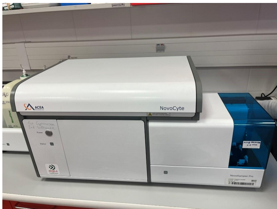
Obrázek 6 - Průtokový cytometr (Novocyte 3000, Acea Biosciences, Aglient, Santa Clara, Californie, USA) (archiv autora).
