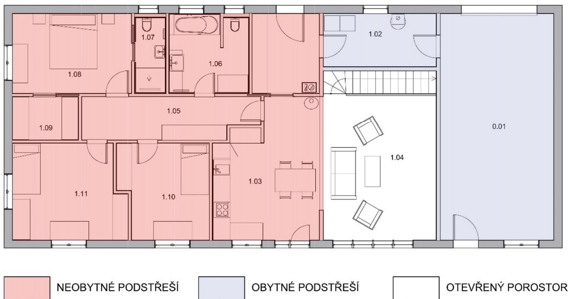
Obr. 33: Půdorys objektu s vyznačeným rozdílným zastropěním
