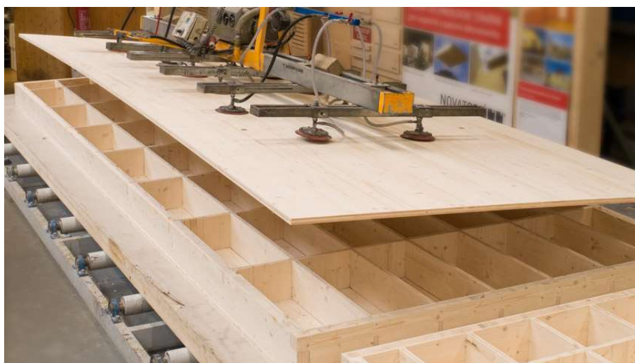
Obr. 7: Výroba skříňového CLT panelu (AGROP Nova a.s., 2022)
