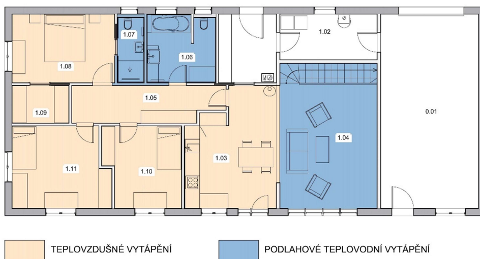
Obr. č. 59: Půdorys 1NP rozdělený dle systému vytápění
