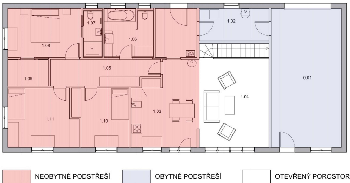
Obr. 33: Půdorys objektu s vyznačeným rozdílným zastropěním
