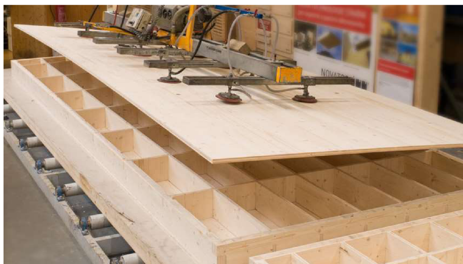
Obr. 7: Výroba skříňového CLT panelu (AGROP Nova a.s., 2022)
