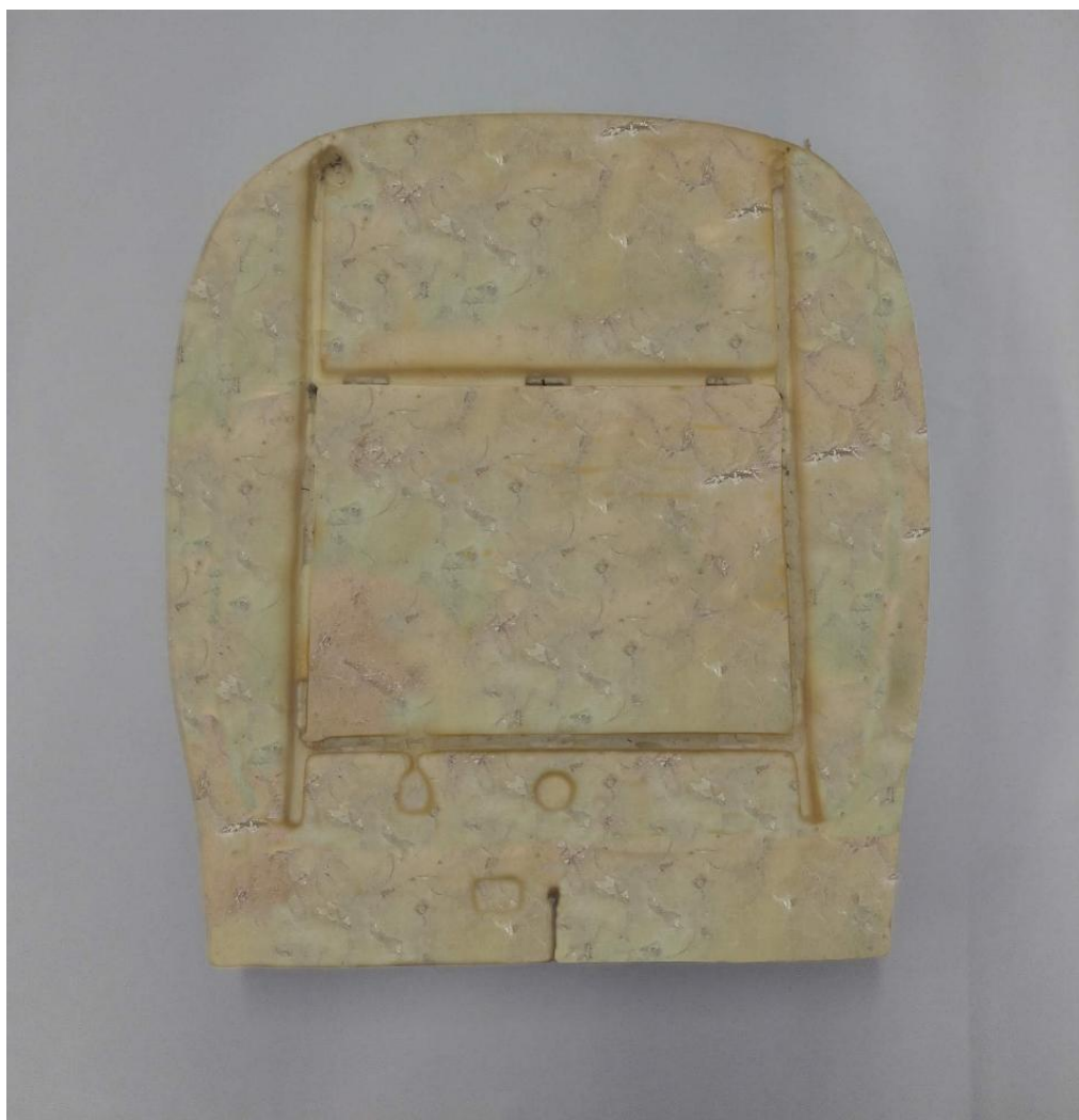
Obr. 5.10 Funkční vzorek výplně automobilové sedačky z kompozitní nízkohustotní pěny s kokosovými vlákny
