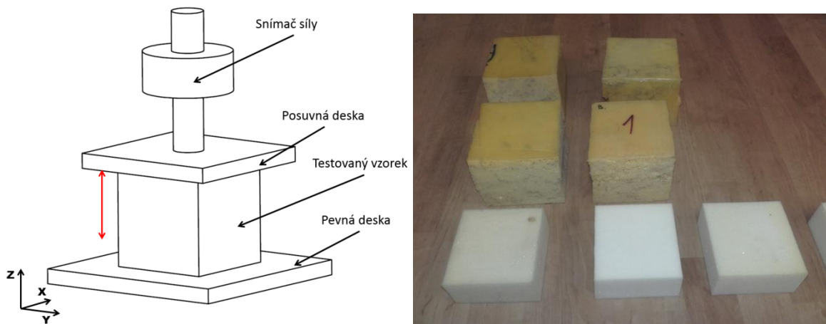
Obr. 4.10 Určení odporu vůči stlačování a) schematické uspořádání měření, b) zkušební vzorky
