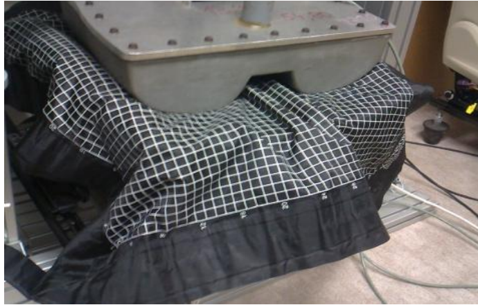
Obr. 5.13 X-senzor pro měření rozložení kontaktního tlaku
