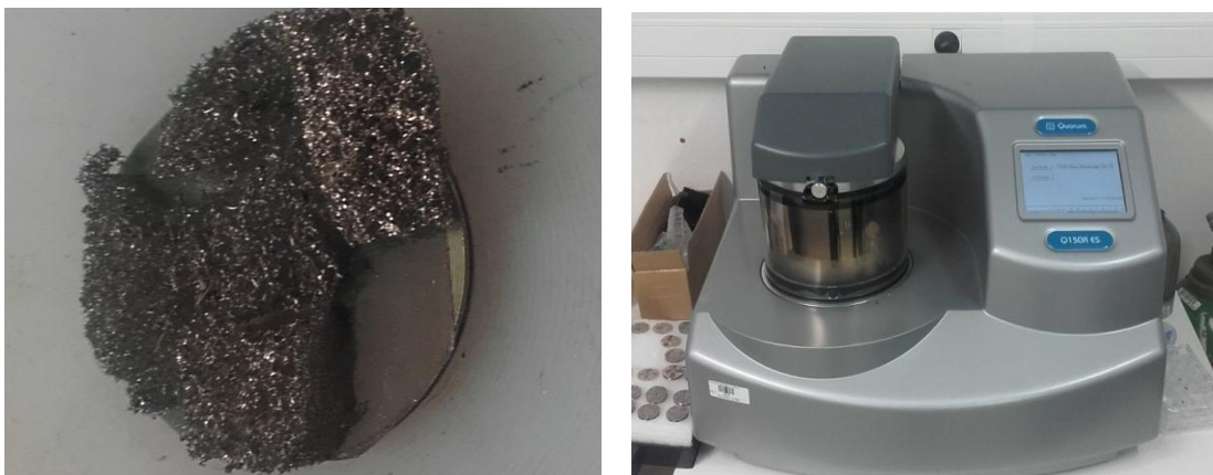
Obr. 4.3 a) Naprašovačka Q150R ES, b) Vzorky s nanesenou vrstvou zlata
