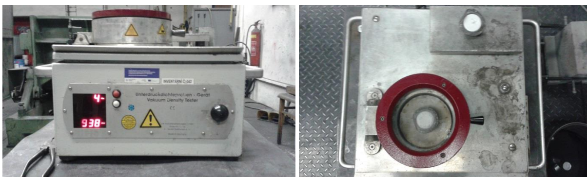
Obr. 3-1 Příklad přístroje Vacuum Density Tester od firmy MK GmbH
