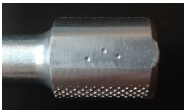
Obr. 3-8 Místa vpichů pro měření tvrdosti
