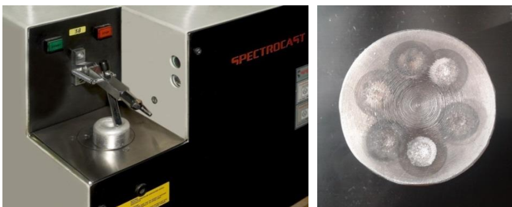
Obr. 3-2 Přístroj SPECTROCAST s měřeným vzorkem
