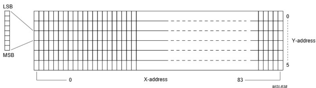
Obr. 2.12: Princip adresování displeje s řadičem PCD8544[18]
