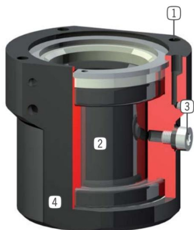
Obr. 7 Řez chapadlem s pryžovou membránou [3]
