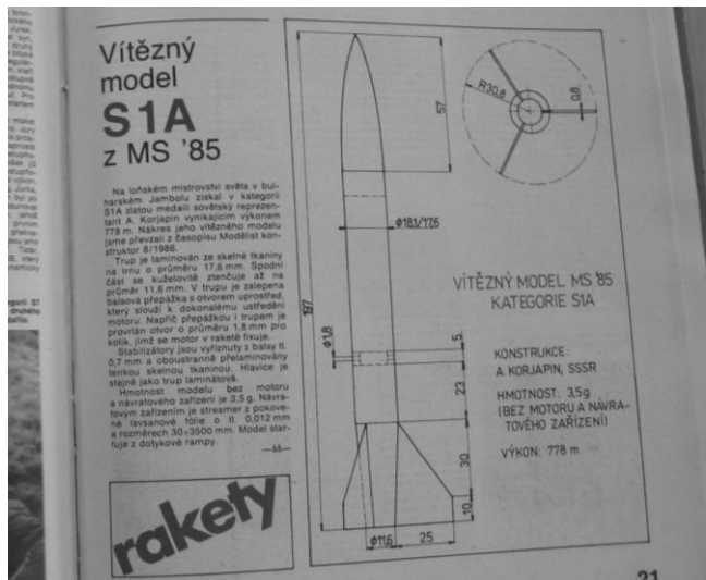
Obrázek 5: Plánek ke stavbě vítězného modelu rakety 212
