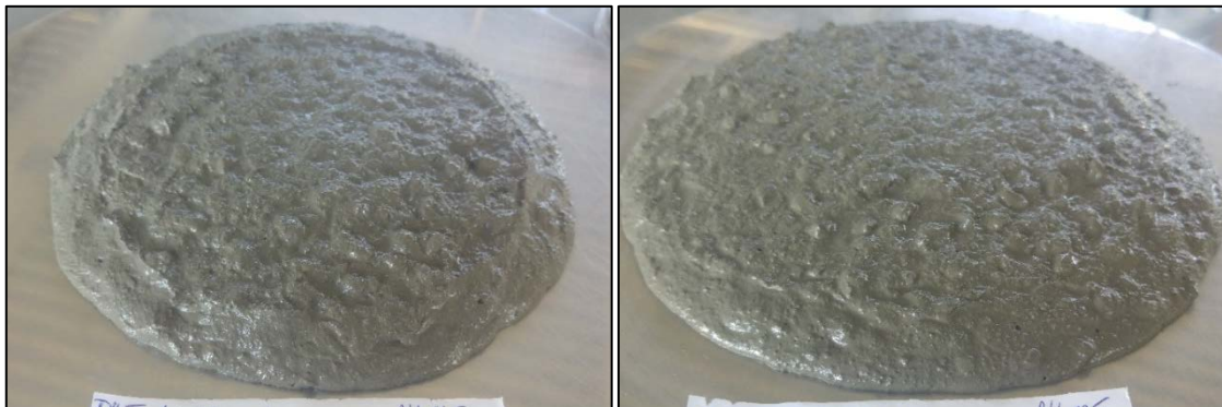
Obr. 19 Rozdílná konzistence receptury 20 % ETU 450 s optimálním a vysokým „w“
