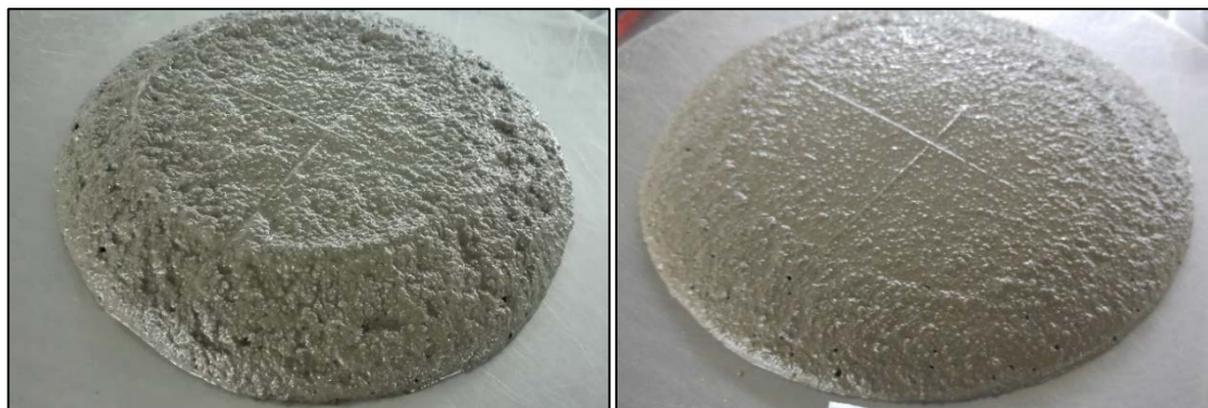
Obr. 17 Zkouška rozlitím u receptur 10 % EOS 530 a 10 % Sklo 541
