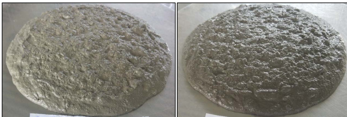
Obr. 20 Zkouška rozlitem u receptury REF_PH3 a 40 % ETU 530
