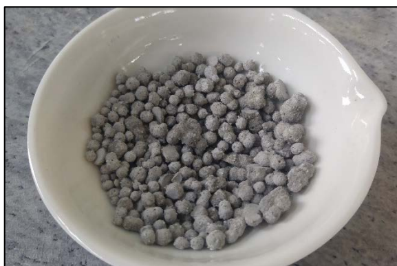
Obr. 21 Kamenivo vzniklé při počátku hydratačních procesů potěru PH3.
