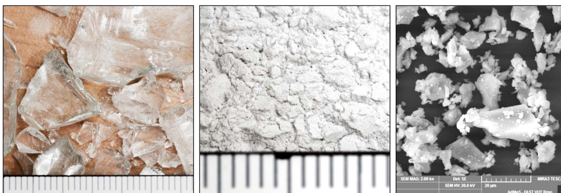
Obr. 13 Drcené obalové sklo (surové, mleté, mikroskopický snímek mletého)
