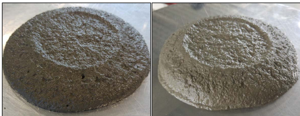
Obr. 15 Zkouška rozlitím u receptury 40 % EOS 530 a 40 % Sklo 541
