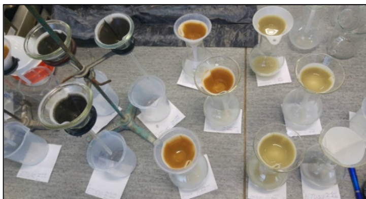
Obr. 9 Filtrování jednotlivých surovin během zkoušky nasákavosti
