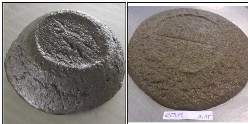
Obr. 16 Zkouška rozlitím u receptury 40 % ETU 450 a 40 % ETU 02
