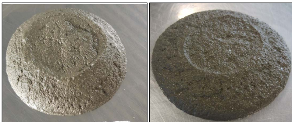
Obr. 14 Zkouška rozlitím u směsi REF a receptury 40 % ETU 530
