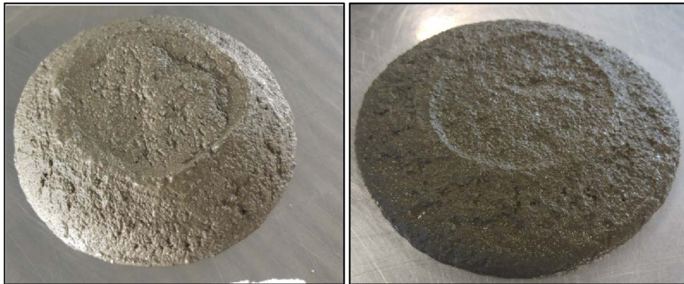
Obr. 14 Zkouška rozlitím u směsi REF a receptury 40 % ETU 530
