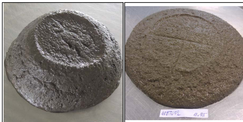
Obr. 16 Zkouška rozlitím u receptury 40 % ETU 450 a 40 % ETU 02
