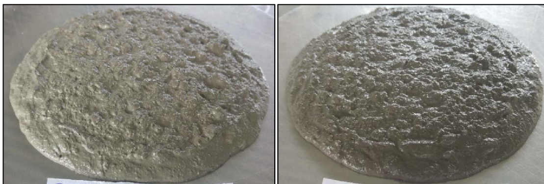
Obr. 20 Zkouška rozlitem u receptury REF_PH3 a 40 % ETU 530
