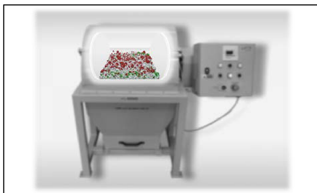
Obr. 10 Model omílacího bubnu s virtuálním materiálem [Výzkumná zpráva TAČR TA04010143-2016V001]
