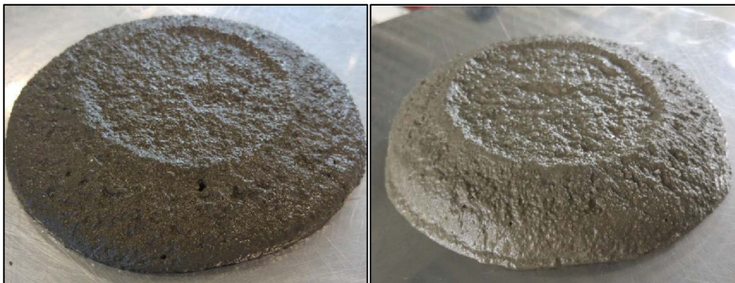
Obr. 15 Zkouška rozlitím u receptury 40 % EOS 530 a 40 % Sklo 541
