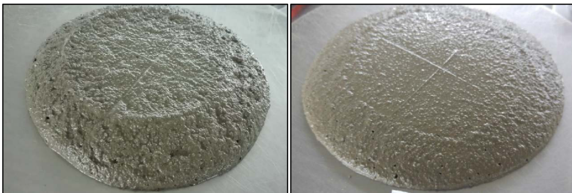
Obr. 17 Zkouška rozlitím u receptur 10 % EOS 530 a 10 % Sklo 541
