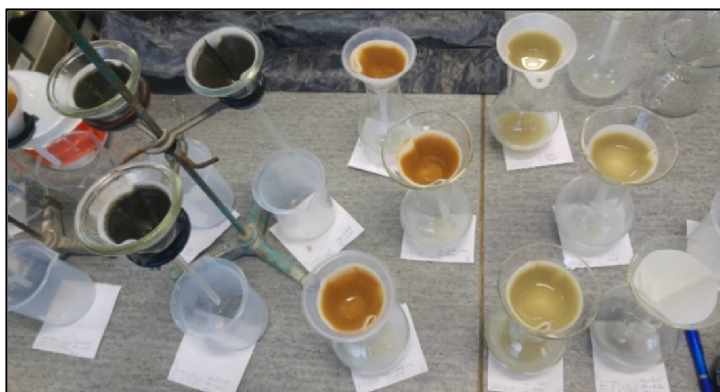
Obr. 9 Filtrování jednotlivých surovin během zkoušky nasákavosti
