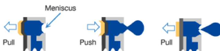
Obrázek 3: Zjednodušený mechanismus tvorby kapek inkoustu piezoelektrickou tiskovou hlavou [12].
