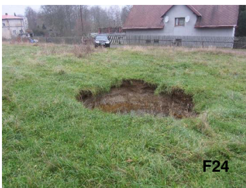
F24+F25 - Tato propadlina se vytvořila na rekultivovaném území- pastvině nad východním důlním polem bývalého dolu Michal ve Starém Sedle těsně za projíždějícím traktorem 1. 12. 2014. Protože měla průměr i hloubku 3,5 metru, traktor by tam určitě zapadl celý (JISKRA).
