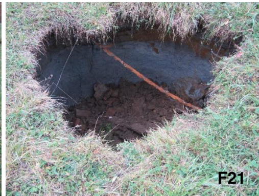
F20+F21 - Propadlina na rekultivovaném území - pastvině nad východním důlním polem bývalého dolu Michal ve Starém Sedle 1. 11. 2011. Propadlina měla průměr 2,4 metru a hloubku 2,0 metru (JISKRA).
