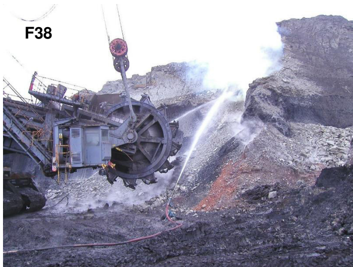
F38 - Hnědouhelná sloj při lomovém dobývání uhlí, postižená historickou hlubinnou těžbou uhlí. Jakmile je důlní chodba kolesem otevřena, začíná s přístupem vzduchu hořet. Místo je třeba uhasit, vychladit a odtěžit.
