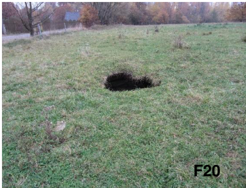
F20+F21 - Propadlina na rekultivovaném území - pastvině nad východním důlním polem bývalého dolu Michal ve Starém Sedle 1. 11. 2011. Propadlina měla průměr 2,4 metru a hloubku 2,0 metru (JISKRA).
