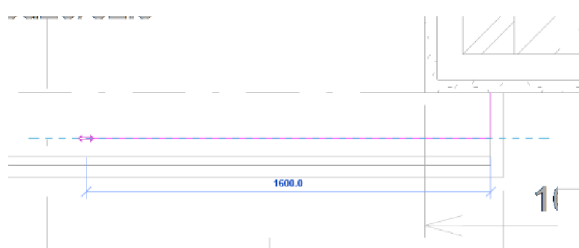
Obr. 105 Tvorba trajektorie zábradlí
