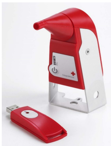
Obrázek 12 Zařízení pro ovládní PC pomocí pohybu úst, zdroj: petit-os.cz
