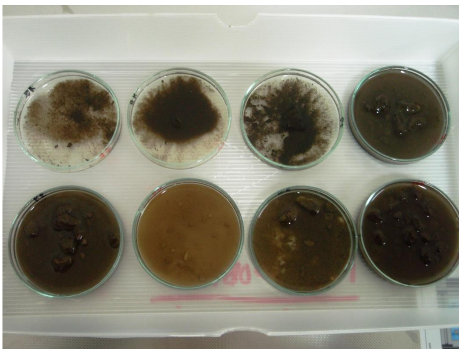
Příloha č. 9: Sušení vzorků detritu na Petriho miskách před vložením do laboratorní sušárny (foto: Veronika Hodaňová).
