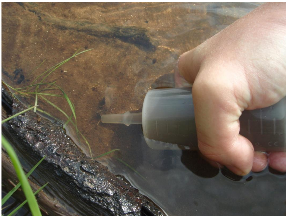
Příloha č. 6: Odebrání deponovaného detritu pomocí nasávací stříkačky v místě kumulace detritu (foto Jan Švanyga).
