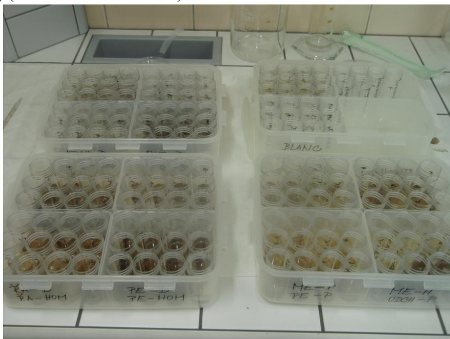
Příloha č. 9: Sušení vzorků detritu na Petriho miskách před vložením do laboratorní sušárny (foto: Veronika Hodaňová).
