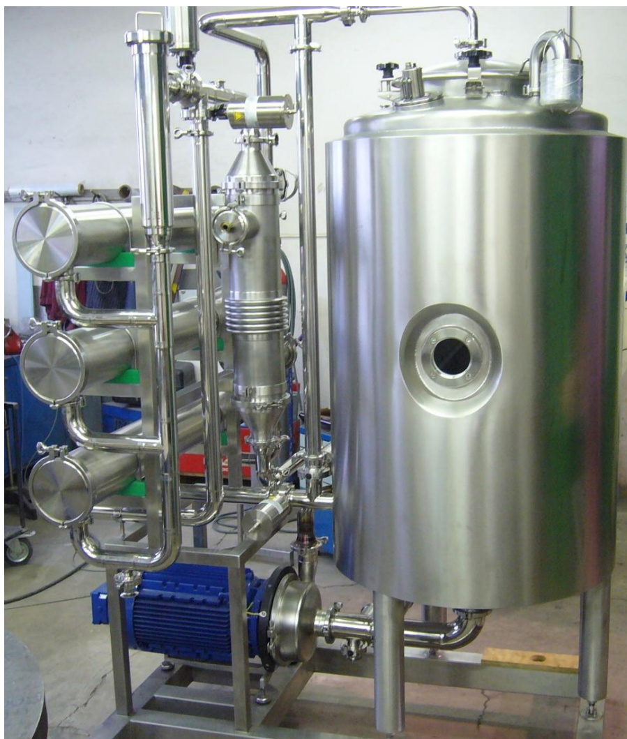
Obr. 1- Výrobek Intero Chmelan, při jehož výrobě bylo použito orbitální i ruční svařování
