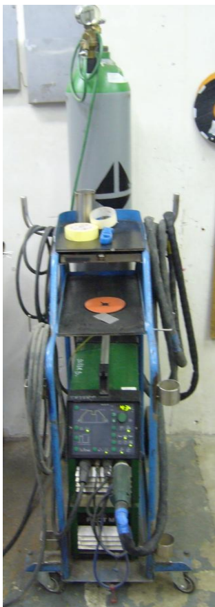
Obr. 9 Svařovací zdroj – vybaven metodou zapalování elektrického oblouku HF a přidavným vodním chlazením
