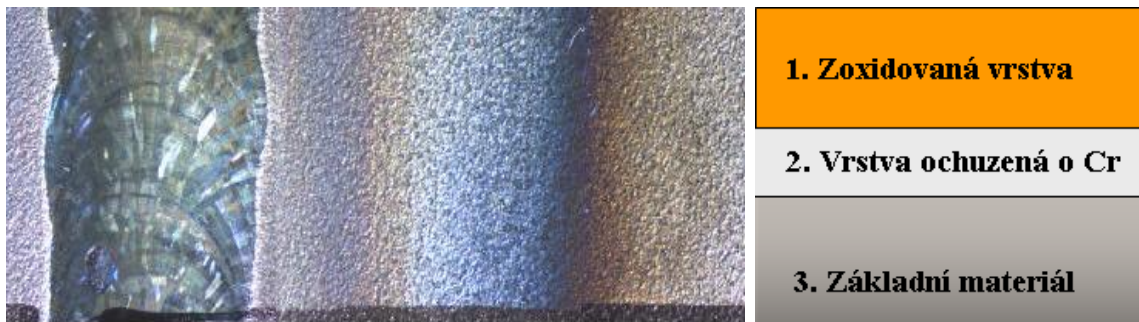
Obr. 25 Vznik oxidační vrstvy a vrstvy ochuzené o chrom; vlevo šířka vzniku oxidační vrstvy od svaru; vpravo graficky znázorněn řez materiálem a vznik vrstev [16]
