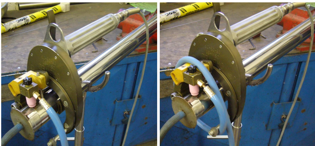
Obr. 11 Otevřená orbitální hlava; vlevo před namotání přívodní hadice; vpravo po namotání přívodní hadice
