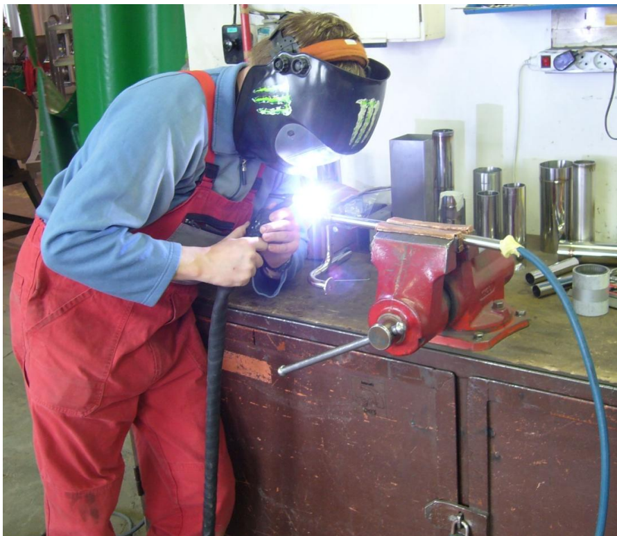
Obr. 8 Ruční svařování metodou TIG
