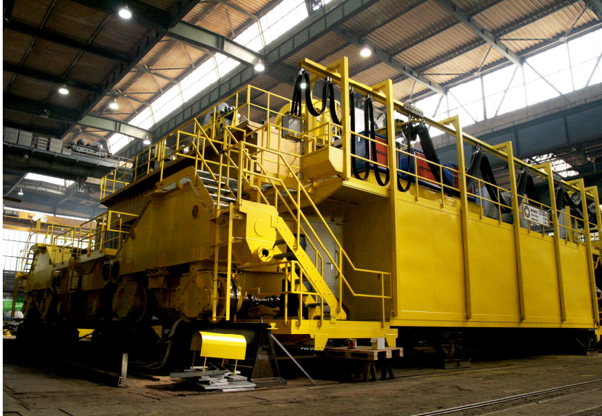
Obrázek 2 Předmontáž jeřábu ve výrobní hale
