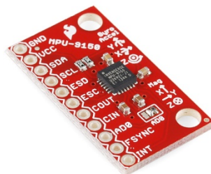
Obr. 11 : SiP modul MPU-9150 kombinující tříosý gyroskop, akcelerometr a digitální kompas [13]
