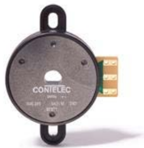
Obr. 10 : Děrový snímač úhlu s rozsahem 340^\circ a rozlišením 0,3^\circ s garancí 2mil cyklů [12]
