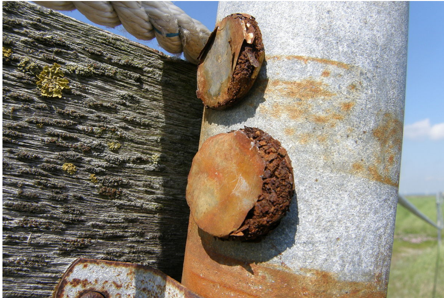
Obr. 2.7: Neodymový magnet vystavený vlivu okolí po 5 měsících[14]
