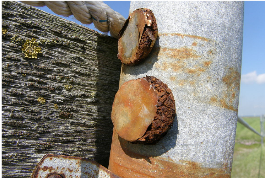
Obr. 2.7: Neodymový magnet vystavený vlivu okolí po 5 měsících[14]
