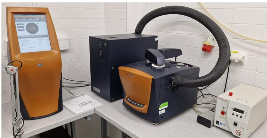
Obrázek 13: Kalorimetr Discovery DSC vybavený příslušenstvím Lumen Dynamics Omnicure .
