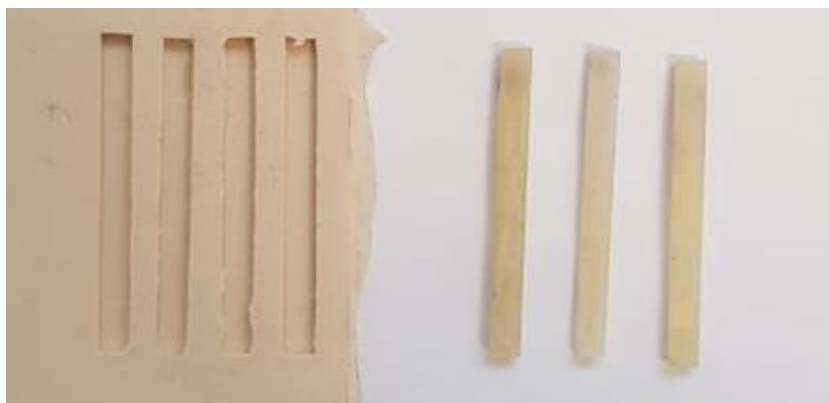
Obrázek 12: Lukoprenová forma a připravené trámečky.
