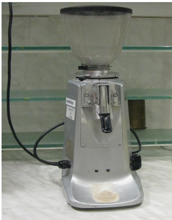
Obr. 1 Mlýnek využívaný k mletí zrna ječmene
