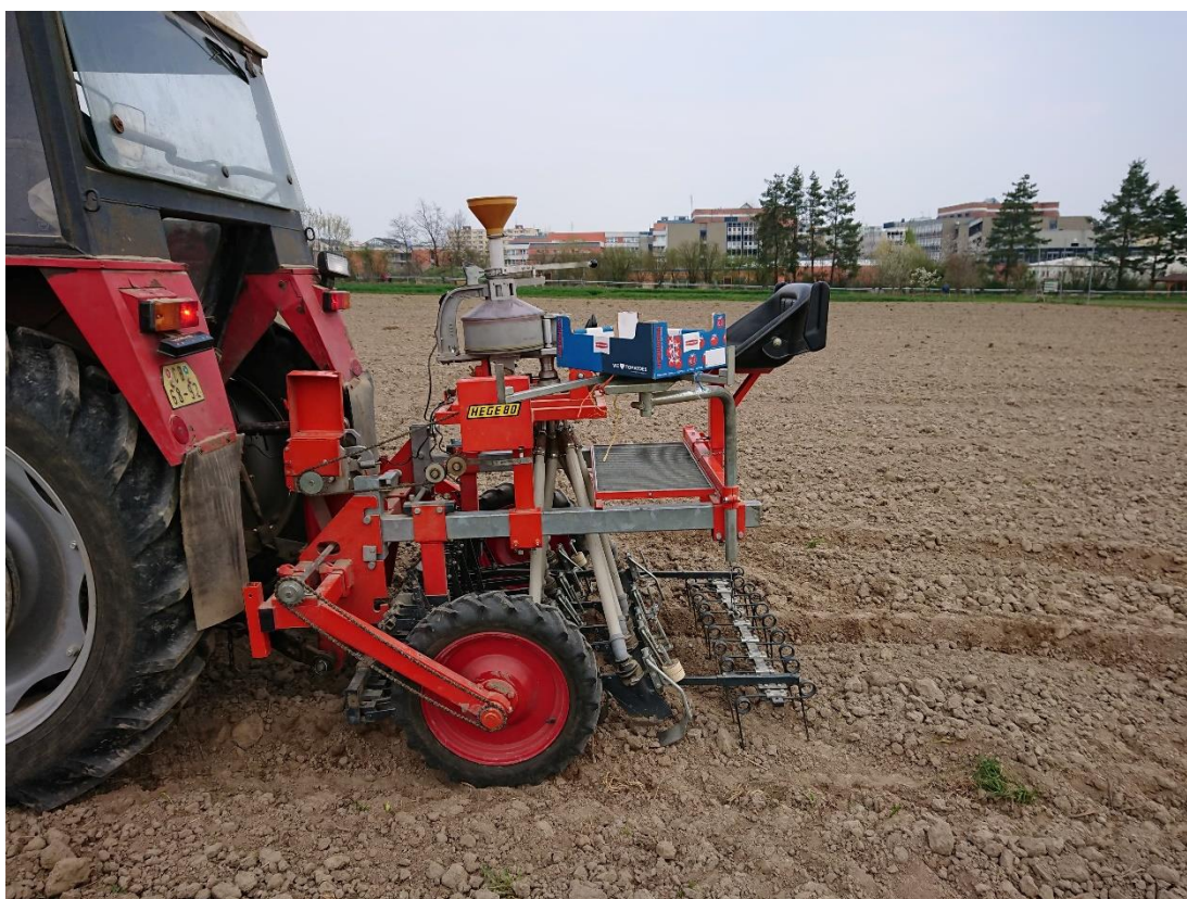
Obrázek 4: Zakládání porostů pomocí maloparcelového secího stroje
