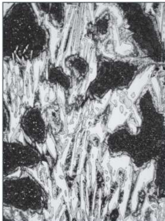
Obr. 12 Ledeburiticko-sorbitická struktura litiny s vysokým obsahem chromu OLVIT 70 [97].
