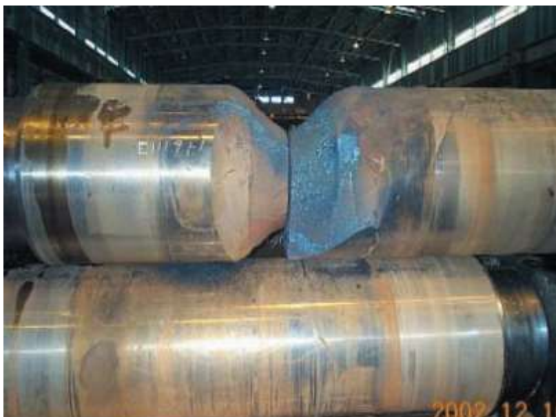
Obr. 129 Roztržení jádra pracovního válce.
