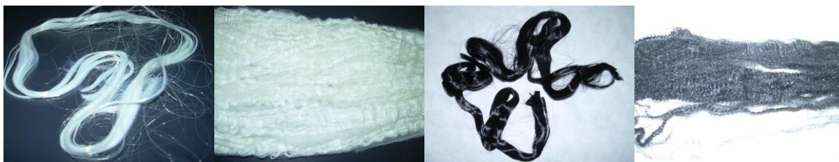
Obr. 12 Nedloužené čiré vlákno, dloužené čiré vlákno, nedloužené černé vlákno, dloužené černé vlákno
