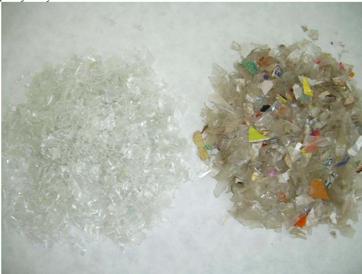
Obr. 8 Porovnání PET flakes z mokrého a suchého procesu
