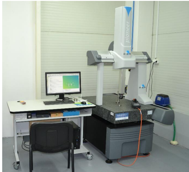
Obr. 8 Portálový měřicí stroj DEA Pioneer
