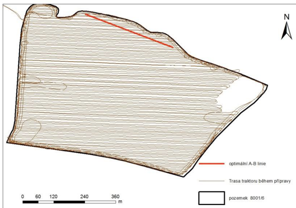
Obr. 30: Modelová trajektorie jízdy strojů a původní jízdy pořizené záznamem u pozemku 8001/6
