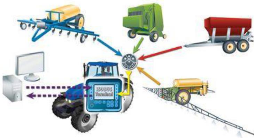
Obr. 7: ISOBUS propojení všech systémů pomocí universální sběrnice
