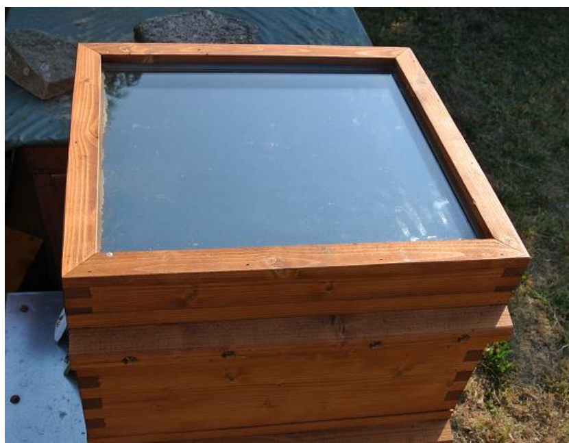
Obr. 15: Horní pohled na termosolární strop.
