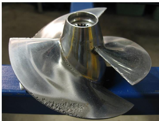
Obrázek 22: Součást poškozená kavitací[27]
