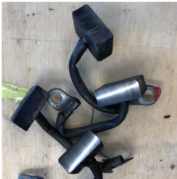
Obrázek 14 - Ukázka opotřebených uhlíkových sběračů
