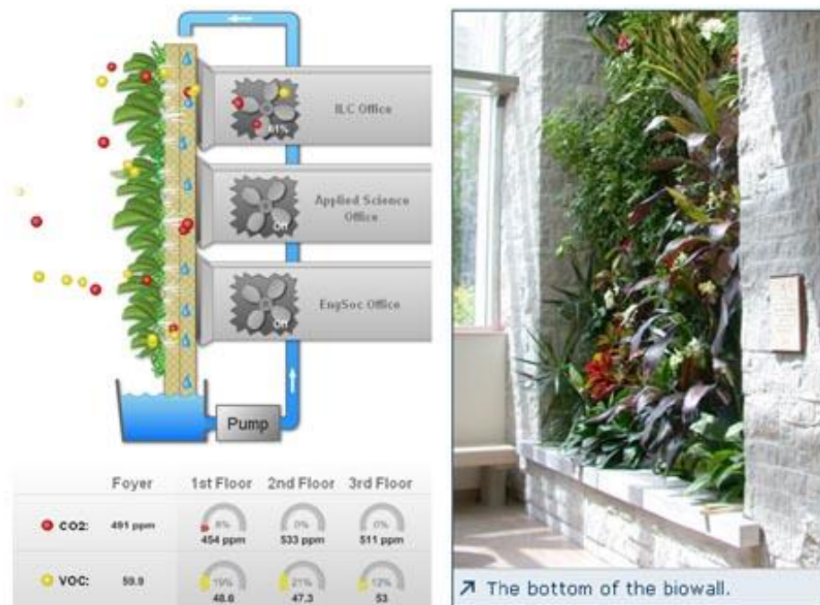
Obrázek 4 Schéma klimatizačního systému s čištěním vzduchu přes rostliny „Biowall“ Zdroj: http://www.hyperexperience.com/?p=403
